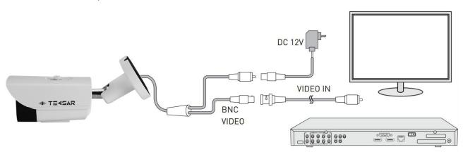
**ВАЖНО!** Перед установкой желательно проверить зону обозрения камеры в предполагаемом месте монтажа. Для этого выполните пункты 8.4, 8.5 перед 8.2. После проверки отключите кабели и действуйте согласно инструкции, начиная с пункта 8.2. Место установки камеры должно быть выбрано таким образом, чтобы минимизировать возможность попадания в объектив прямого солнечного света, под действием которого возможно повреждение светочувствительной матрицы
