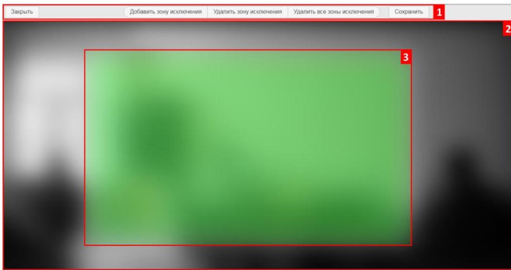
Вы увидите элементы управления (1). снимок с камеры(2) и ,выделенную на нем зеленой рамкой, зону распознавания(3), на которой будет производиться поиск и распознавания номера.
