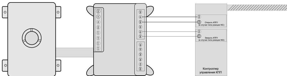
Схема подключения LPR Box “Гидра” (NC)
