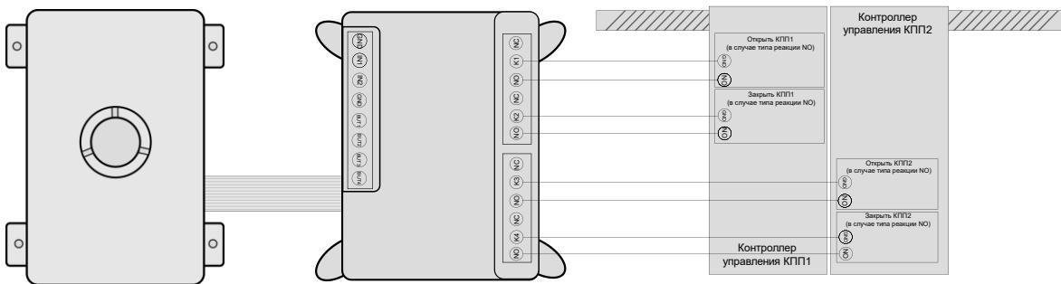
LPR Box поддерживает подключение сетевых реле "Socket-2", "Socket-3", "Socket-4" компании «VKmodule» (<http://vkmodule.com.ua>). Для управления работой одного шлагбаума (один КПП) необходимо два релейных выхода, двух шлагбаумов (два КПП) - четыре релейных выхода. Таким образом, для работы LPR Box "Орф" достаточно одного модуля "Socket-2" или "Socket-3", LPR Box "Гидра" - одного модуля "Socket-4" или двух модулей "Socket-2" либо "Socket-3".
