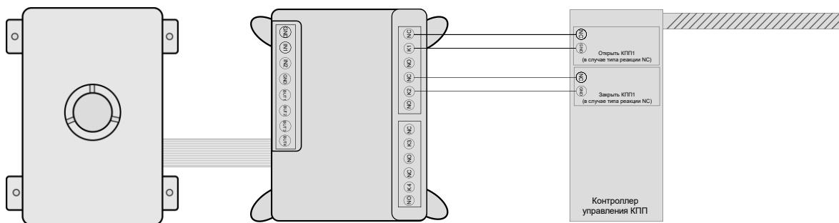
Схема подключения LPR Box “Орф” (NO)
