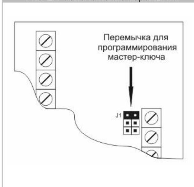
Для записи нового мастер-ключа необходимо: отключить питание устройства и установить переключку J1 (см. рис. 2). Включить устройство (светодиод мигает красным цветом) и приложить на одну секунду новый мастер-ключ к считывателю, при этом светодиод начнет мигать зеленым цветом. Выключить устройство и убрать переключку. Смена мастер-ключа не приводит к сбросу текущих настроек системы. Старый мастер-ключ можно запрограммировать как пользовательский ключ обычный
