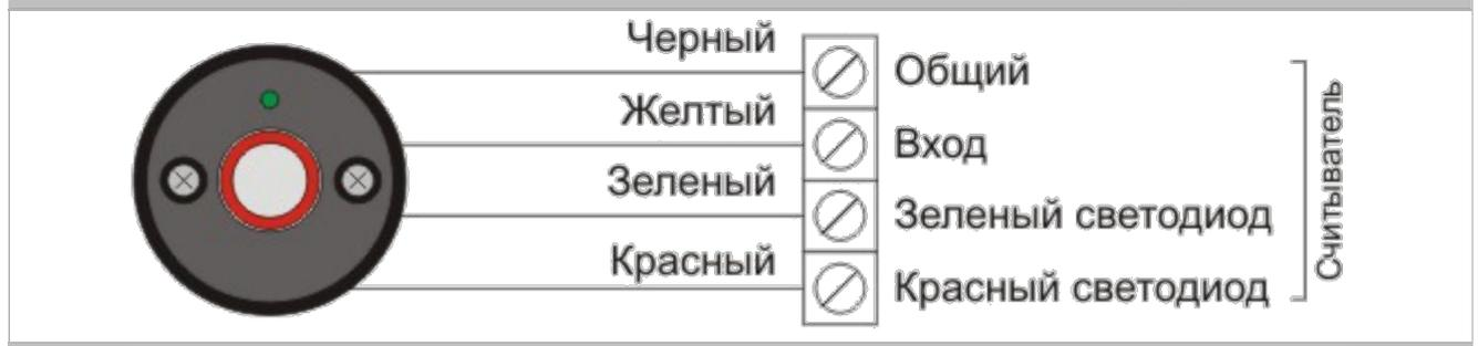
Схема 4. Схема подключения считывателя Proximity карт PR-XX
