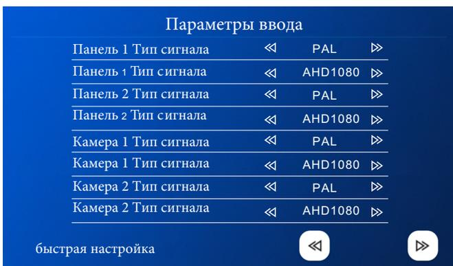
**Примечание:** Входящий видеосигнал должен соответствовать используемому оборудованию, иначе видеосигнал будет отображаться неправильно. Если вы не можете точно знать разрешение и формат входного сигнала, вы можете использовать функцию автоматического обнаружения, тогда система распознает его сама.
