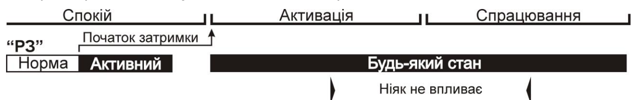
Рисунок 4.5 – Алгоритм роботи входу «P3»
