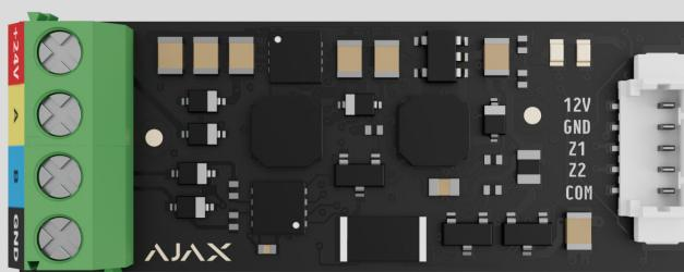
**Transmitter Fibra** – модуль інтеграції для під'єднання стороннього дротового пристрою до системи Аjax. Із його допомогою можна під'єдувати ролети, тривожні кнопки, кнопки виклику невідкладної допомоги, датчики руху для приміщень та вулиці, а також датчики відчинення, вібрації, розбиття скла, газу, протікання, пожежні датчики й інші дротові пристрой.
