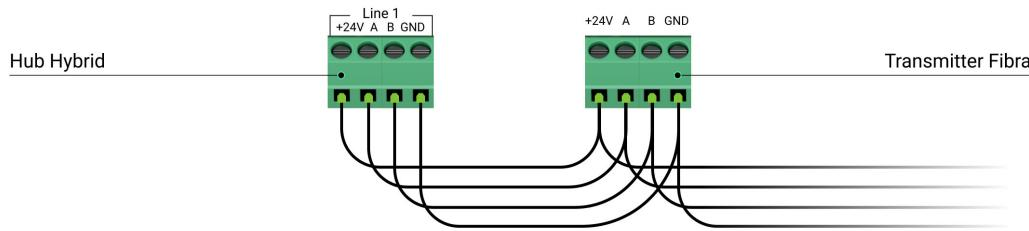
**2.** Якщо Transmitter Fibra – останній пристрій на лінії та ви використовуєте **топологію Промінь**, установіть термінуючий резистор на два контакти, під'єднавши його до сигнальних клем модуля інтеграції. Термінуючий резистор номіналом 120 Ом входить до комплекту хаба.
