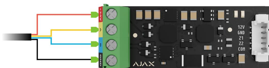
**1.** Якщо Transmitter Fibra – не останній пристрій на лінії Fibra, заздалегідь підготуйте другий кабель. Під'єднайте дроти до клем Transmitter Fibra як показано на схемі нижче.
