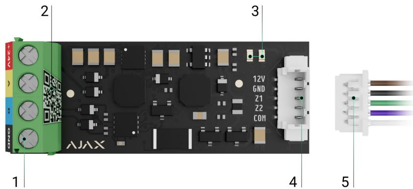
1. Вхідні клеми для під'єднання лінії Fibra до Transmitter Fibra.
