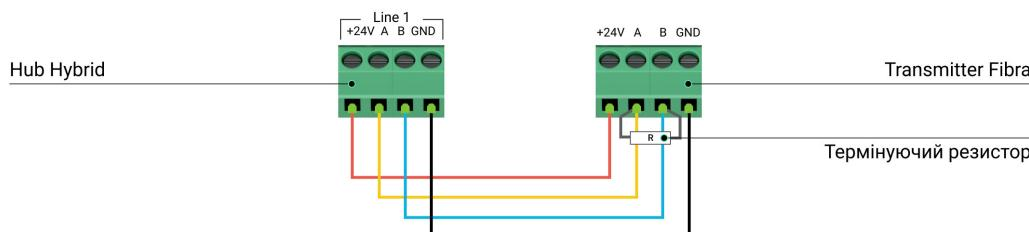
**5.** Під'єднайте комплектну виносну клему до вихідної клеми Transmitter Fibra.
