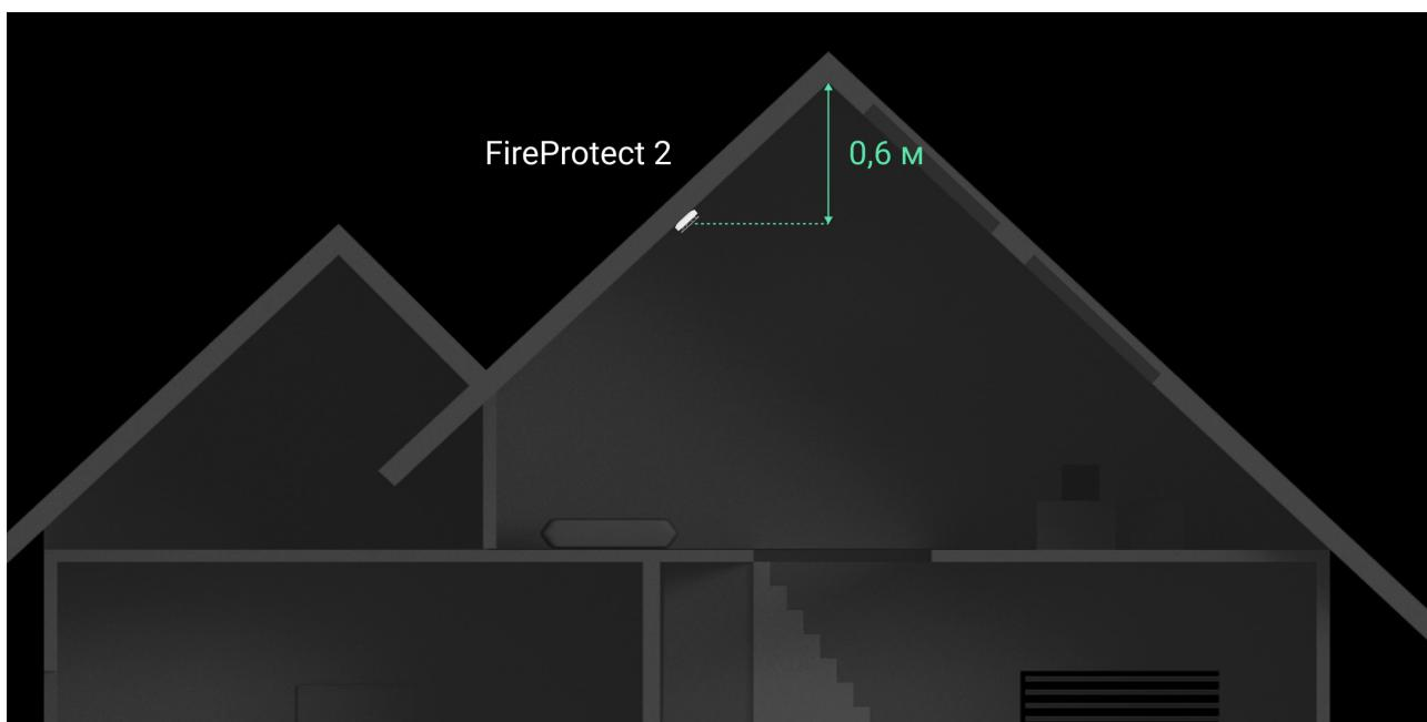
Не рекомендуємо встановлювати датчик на стіну. Таке встановлення допустиме, якщо близько розташовані балки або інші перешкоди заважають встановленню датчика. Встановлення на стіну можливе лише у випадку, якщо датчик розташовується на відстані 15–30 см нижче стелі, але вище дверних отворів.
