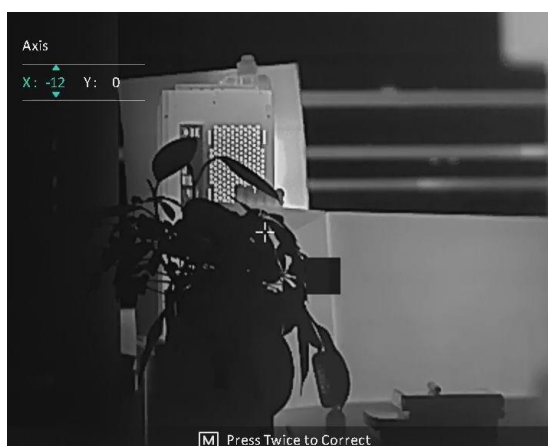
Рисунок 3-6 Коригування дефектних пікселів
