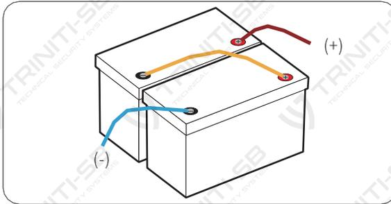
Після послідовного підключення **напруга** акумуляторної системи збільшується пропорційно кількості підключених акумуляторів.
