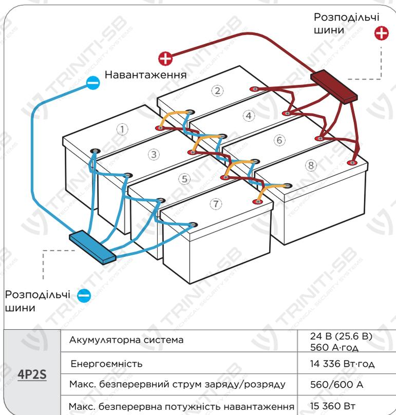
① Оскільки **⊖** клеми ① / ③ / ⑤ / ⑦ з'єднані послідовно з **⊕** клемми ② / ④ / ⑥ / ⑧, **не підключайте** **⊖** ① / ③ / ⑤ / ⑦ до **⊖** навантаження та **⊕** ② / ④ / ⑥ / ⑧ до **⊕** навантаження — інакше батарейна система не зможе з'єднатися послідовно.
