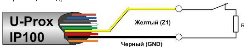
Рис.16. Подключение дверного контакта
