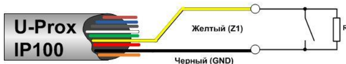
Рис.15. Подключение кнопки запроса прохода
