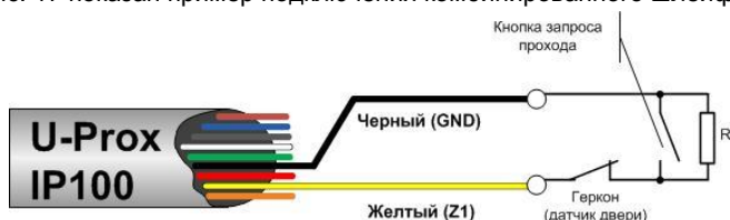
Рис.17. Подключение комбинированного шлейфа
