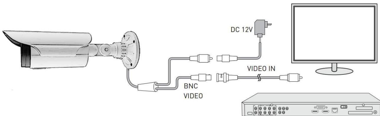
**ВАЖНО!** Перед установкой желательно проверить зону обзора камеры в предполагаемом месте монтажа. Для этого выполните пункты 8.4, 8.5 перед 8.2. После проверки отключите кабели и действуйте согласно инструкции, начиная с пункта 8.2. Место установки камеры должно быть выбрано таким образом, чтобы минимизировать возможность попадания в объектив прямого солнечного света, под действием которого возможно повреждение светочувствительной матрицы
