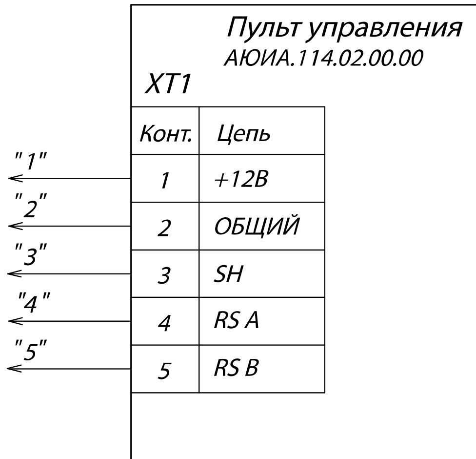
Рисунок Б.2 – Схема электрическая подключения пульта управления АЮИА.114.02.00.00
