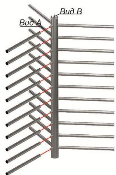
Рис.8– Установка ротора турникета и поводков
