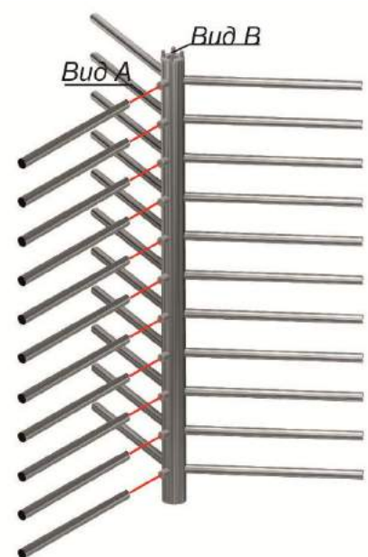
Рис.8– Установка ротора турникета и поводков
