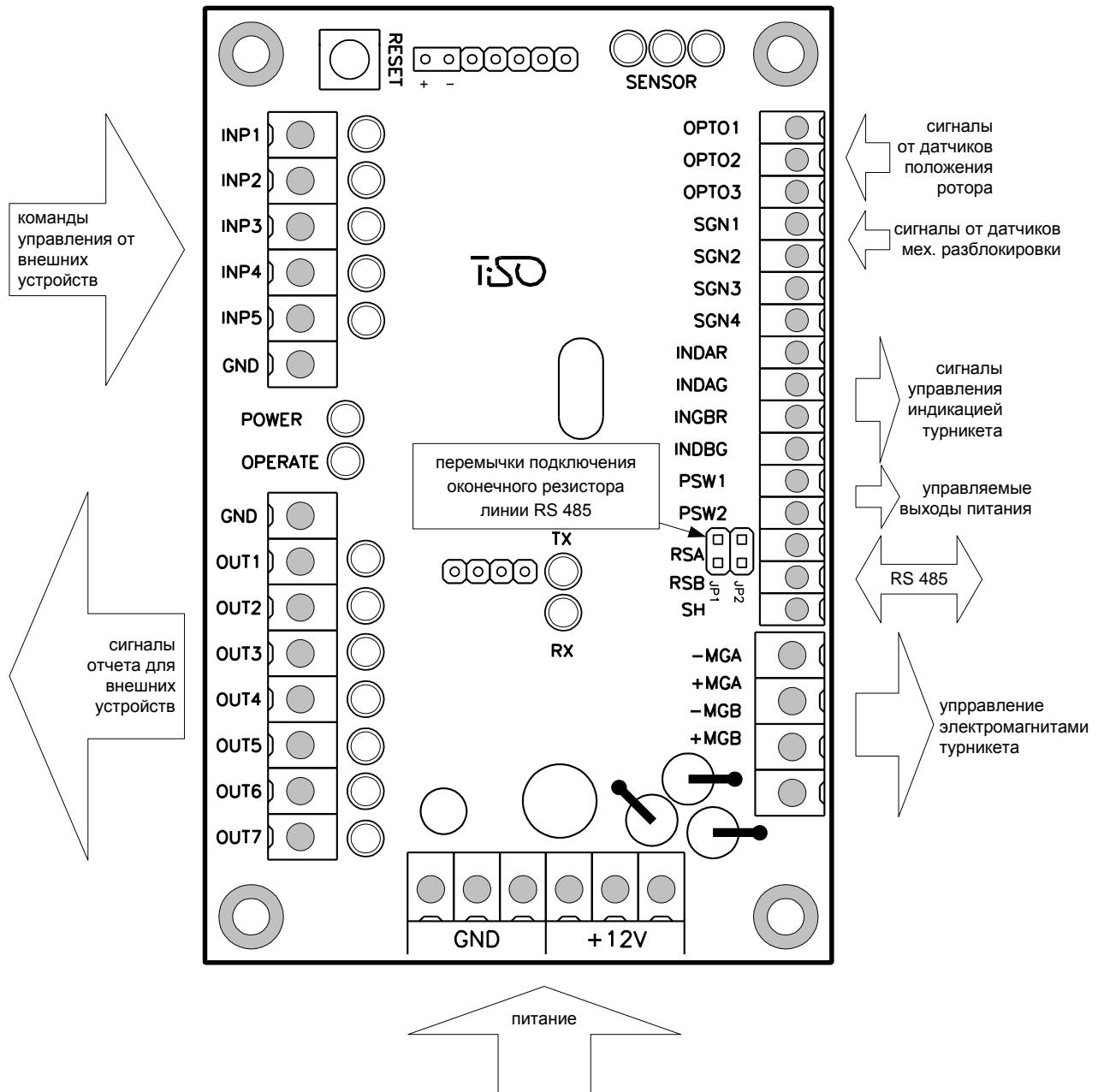
Рисунок 3 – Внешний вид контроллера PCB.112.21.20.00
