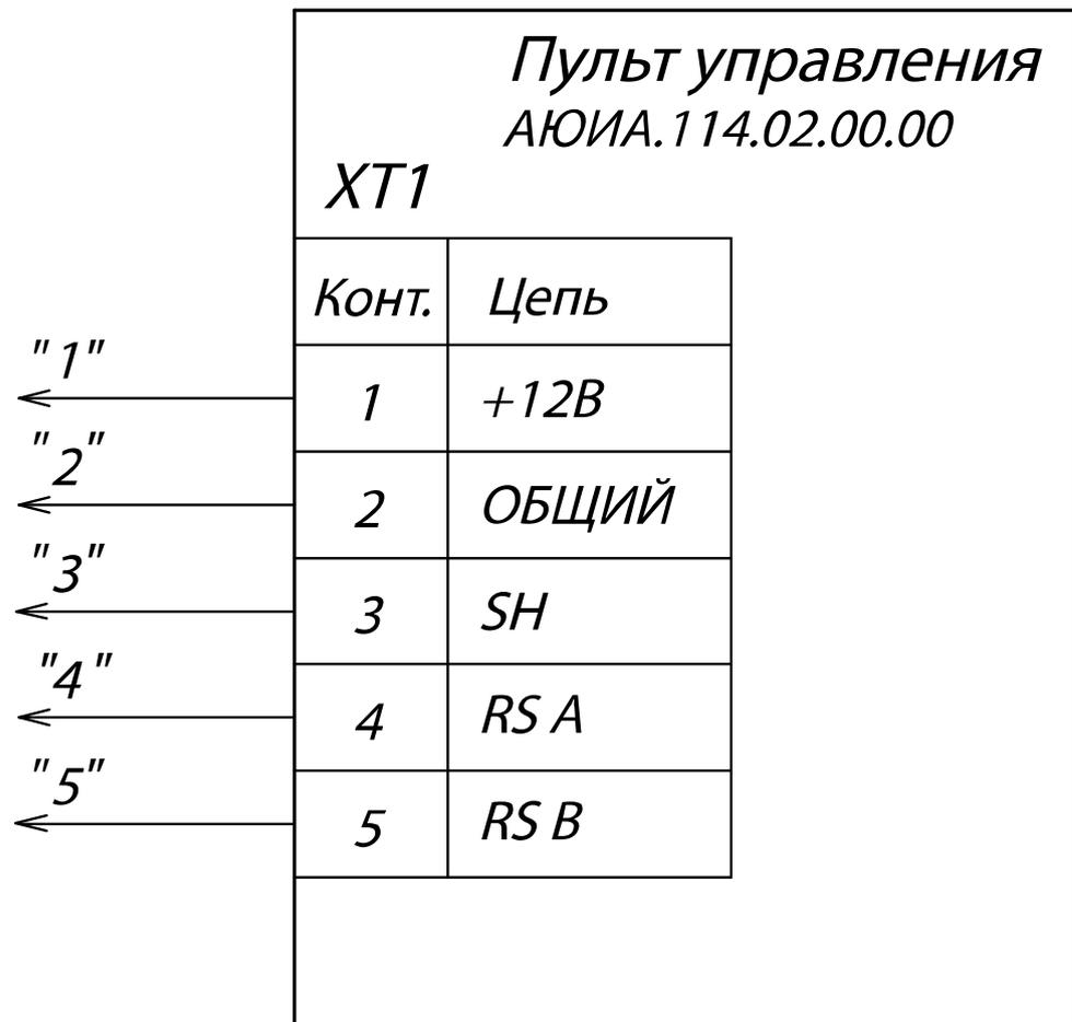
Рисунок Б.2 – Схема электрическая подключения пульта управления
