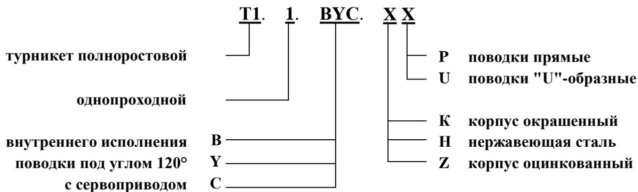
Пример записи обозначения турникета полноростового однопроходного, с сервоприводом, с прямыми поводками и корпусом из нержавеющей стали при заказе:
