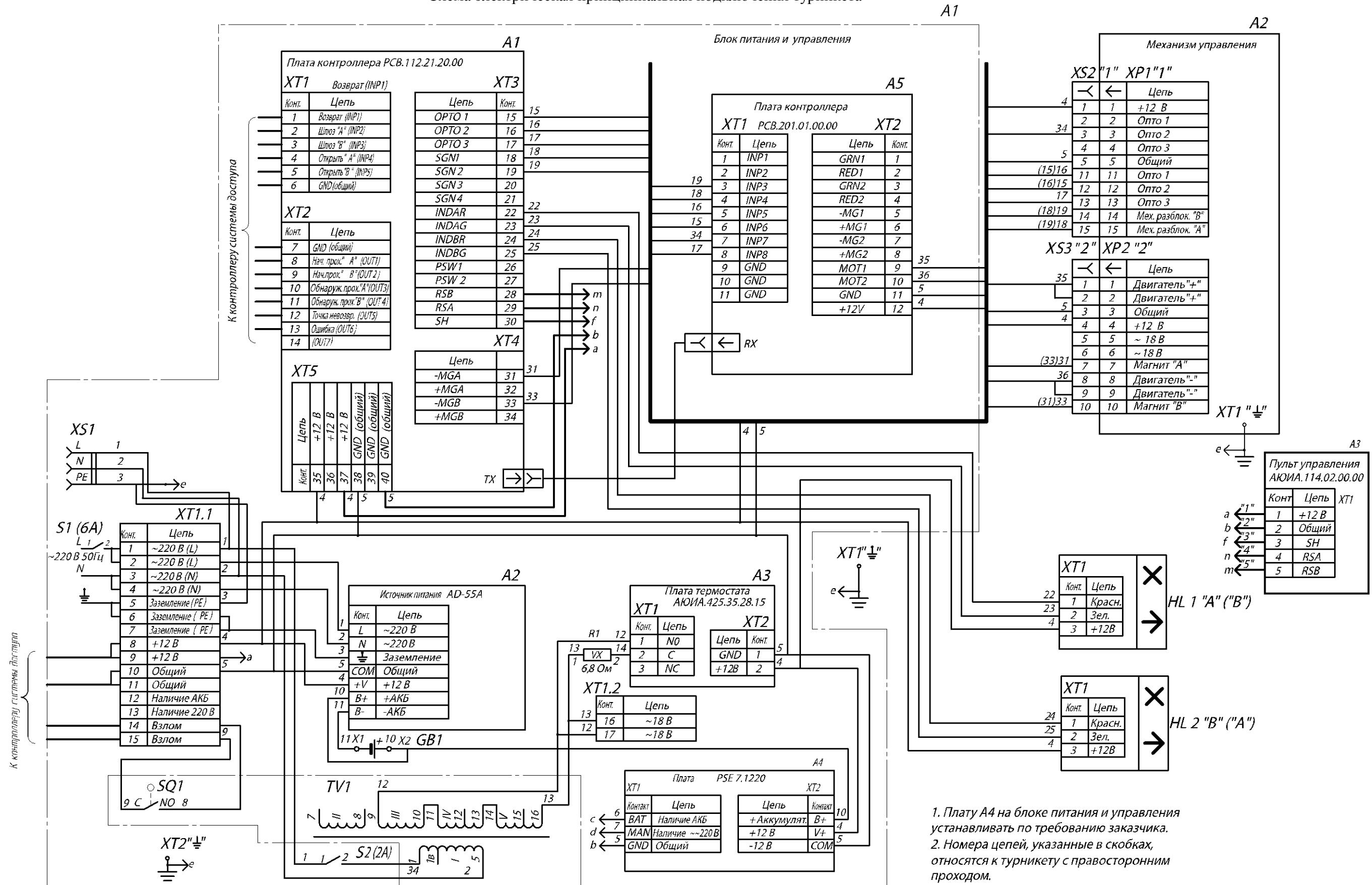
Рисунок В.1 – Схема электрическая принципиальная подключения турнкета
