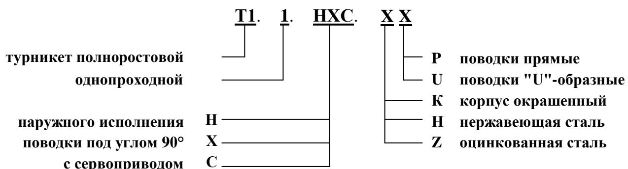
Пример записи обозначения турникета полноростового однопроходного, с сервоприводом, с прямыми поводками и корпусом из нержавеющей стали при заказе:
