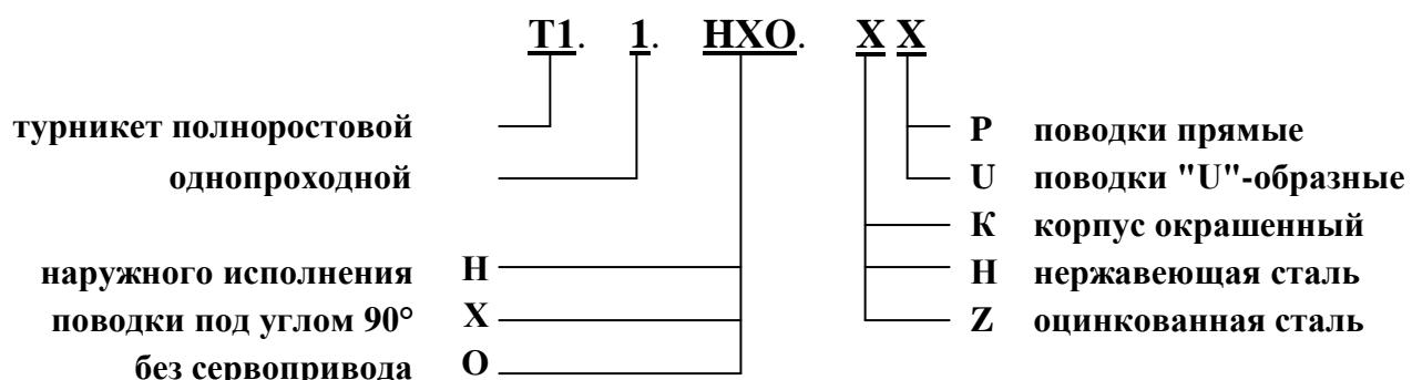
Пример записи обозначения турникета полноростового однопроходного, без сервопривода, с прямыми поводками и корпусом из нержавеющей стали при заказе:
