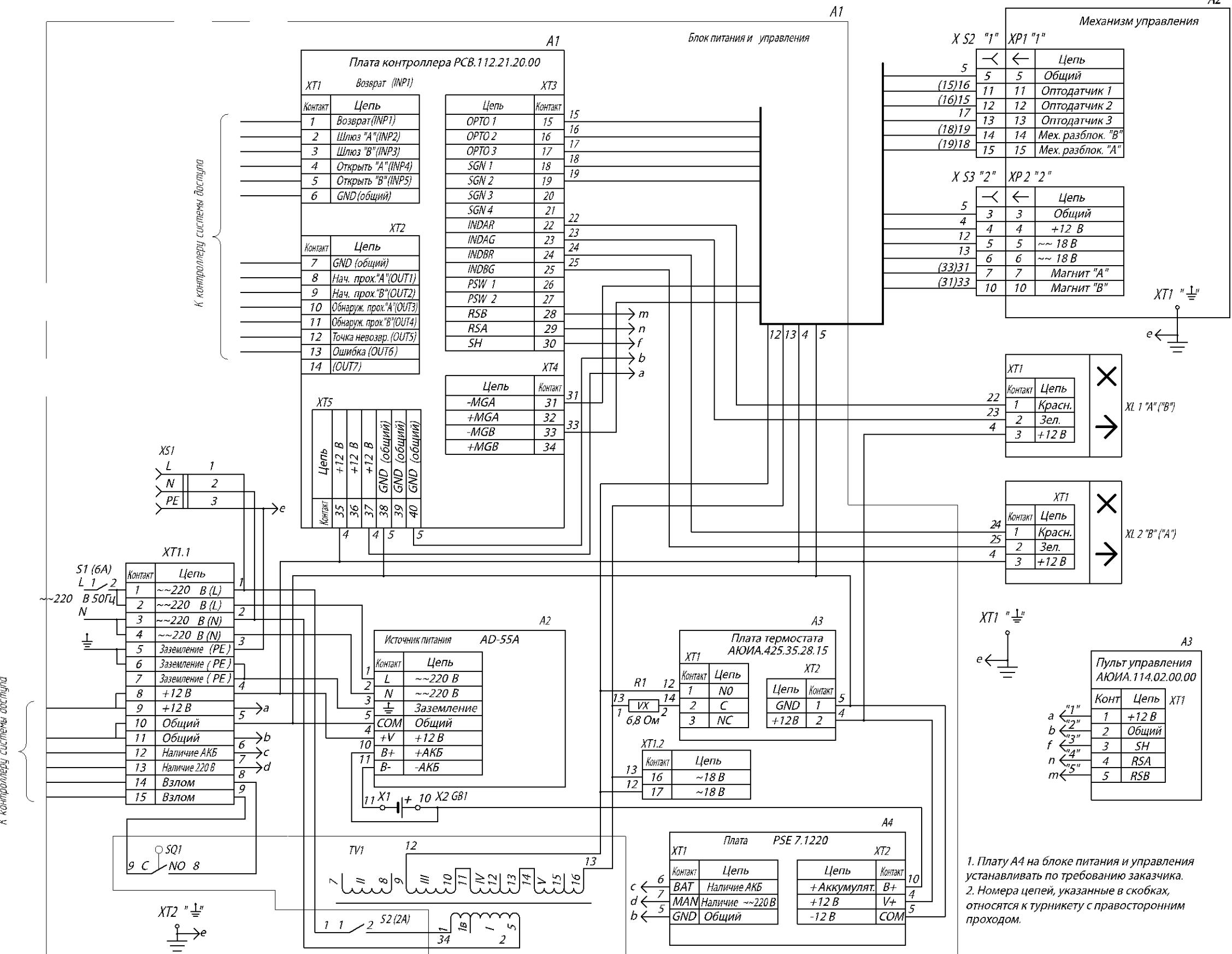
Рисунок В.1 – Схема электрическая принципиальная подключения турнкета
