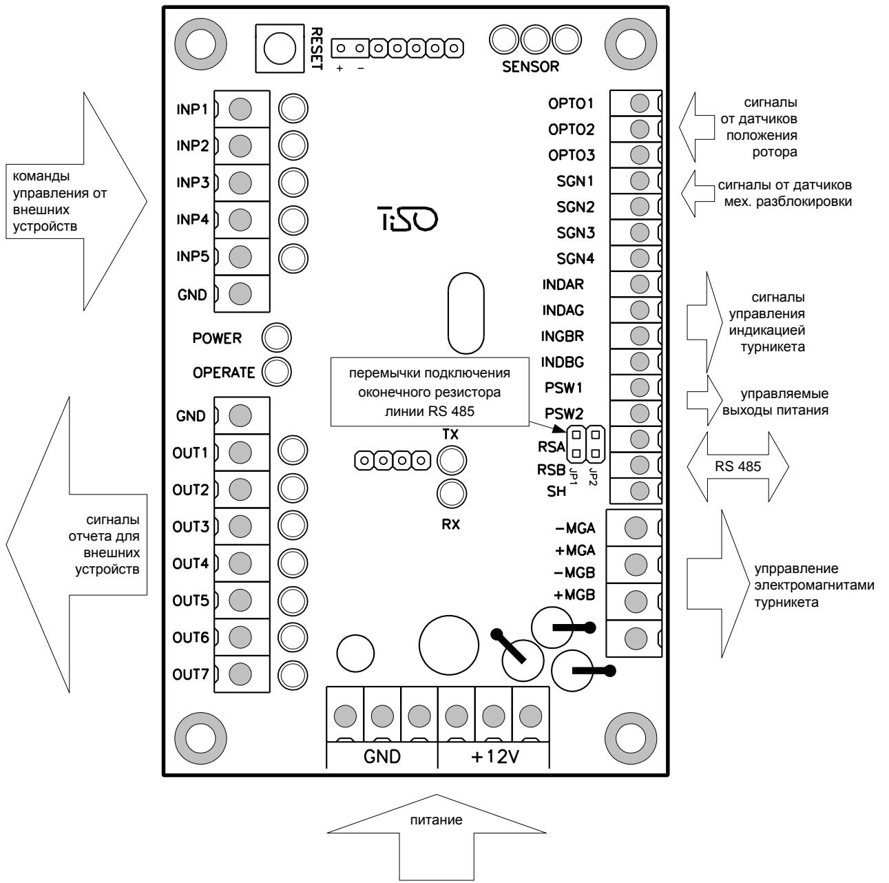
Рисунок 3 – Внешний вид контроллера PCB.112.21.20.00
