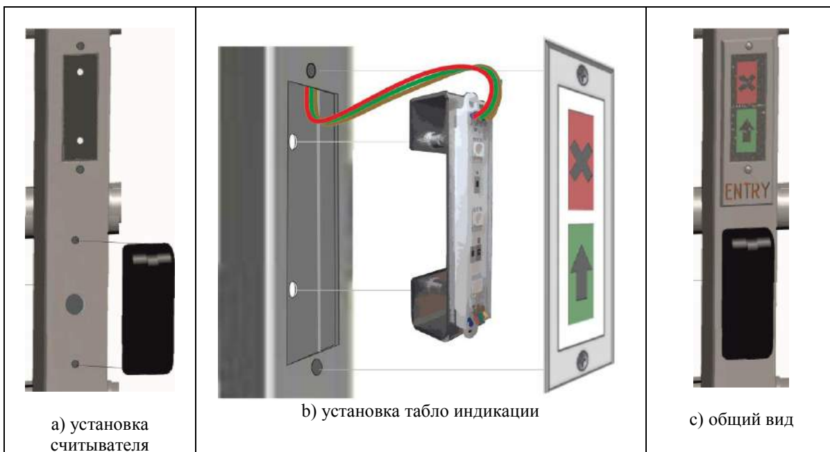
Рис.16 - Установка считывателя бесконтактных карт и табло индикации
