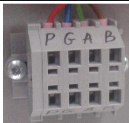
Рисунок 13 – Подключение кабеля связи с пультом управления к клеммам
