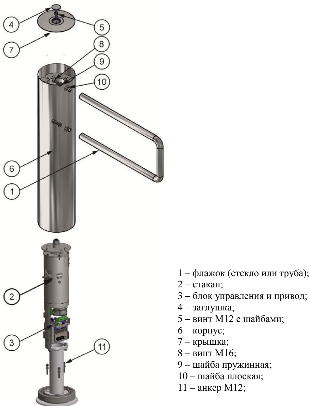
Рис. 2 – Конструкция турникета типа «калитка»
