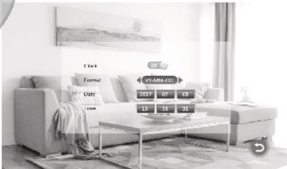
**Часы:** Здесь вы можете включить или выключить часы, отображающиеся на мониторе в режиме ожидания. Если выключить часы, то экран в режиме ожидания будет черным.
