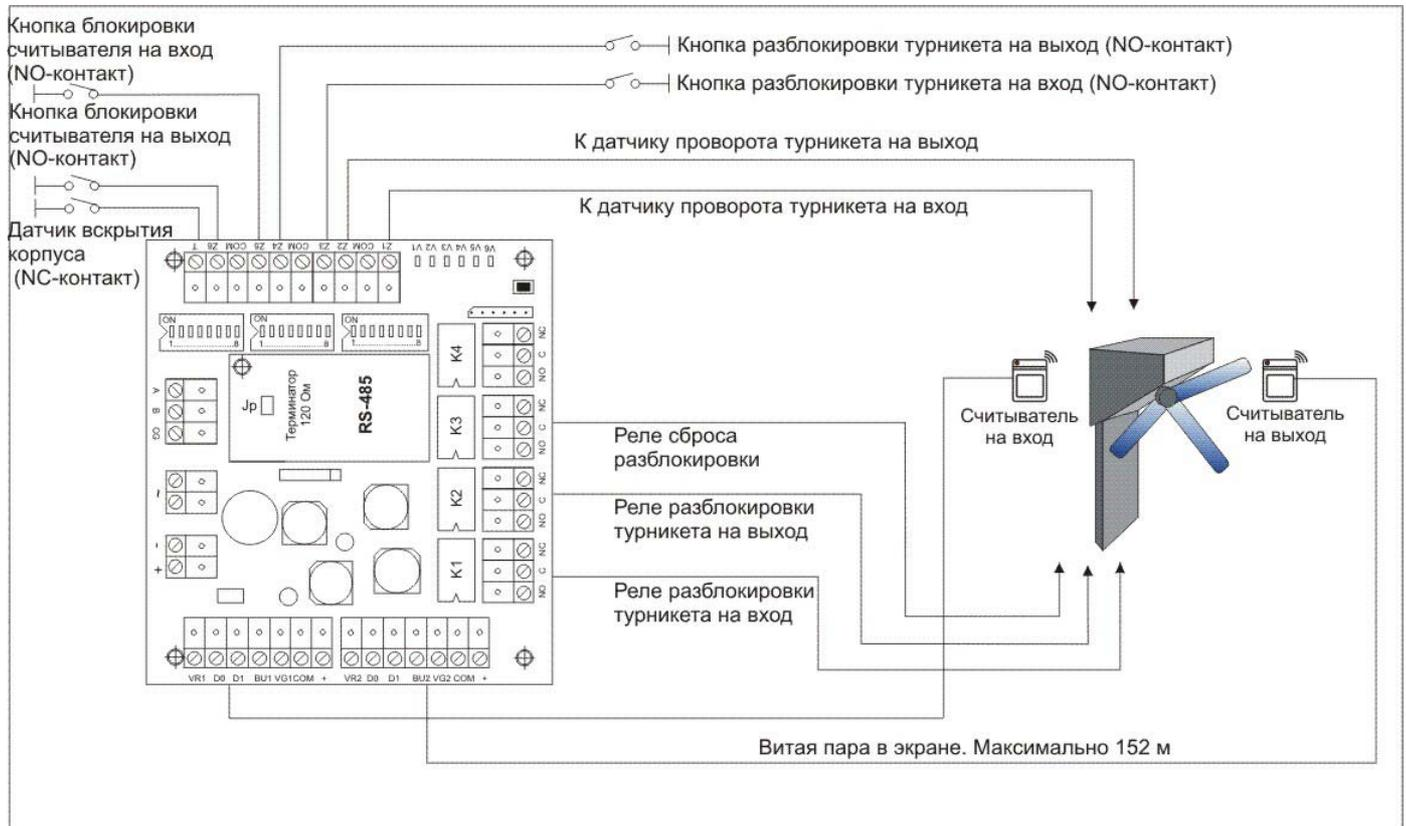
Рис 12. Функциональная схема оборудования точки прохода на основе турникета с независимым получением информации о факте прохода по входу и выходу. Вариант.
