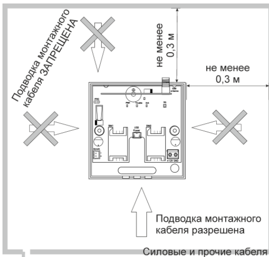
Рис.5. Установка базового блока.
