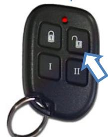
Рис. 25. Кнопка "Снятие" на брелоке
