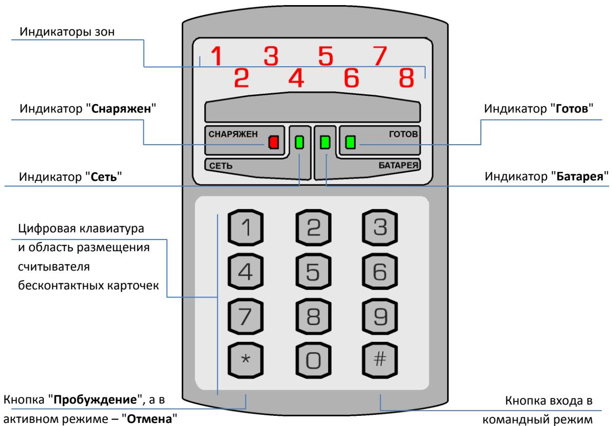
Рис. 12. Беспроводная клавиатура M8022PK
