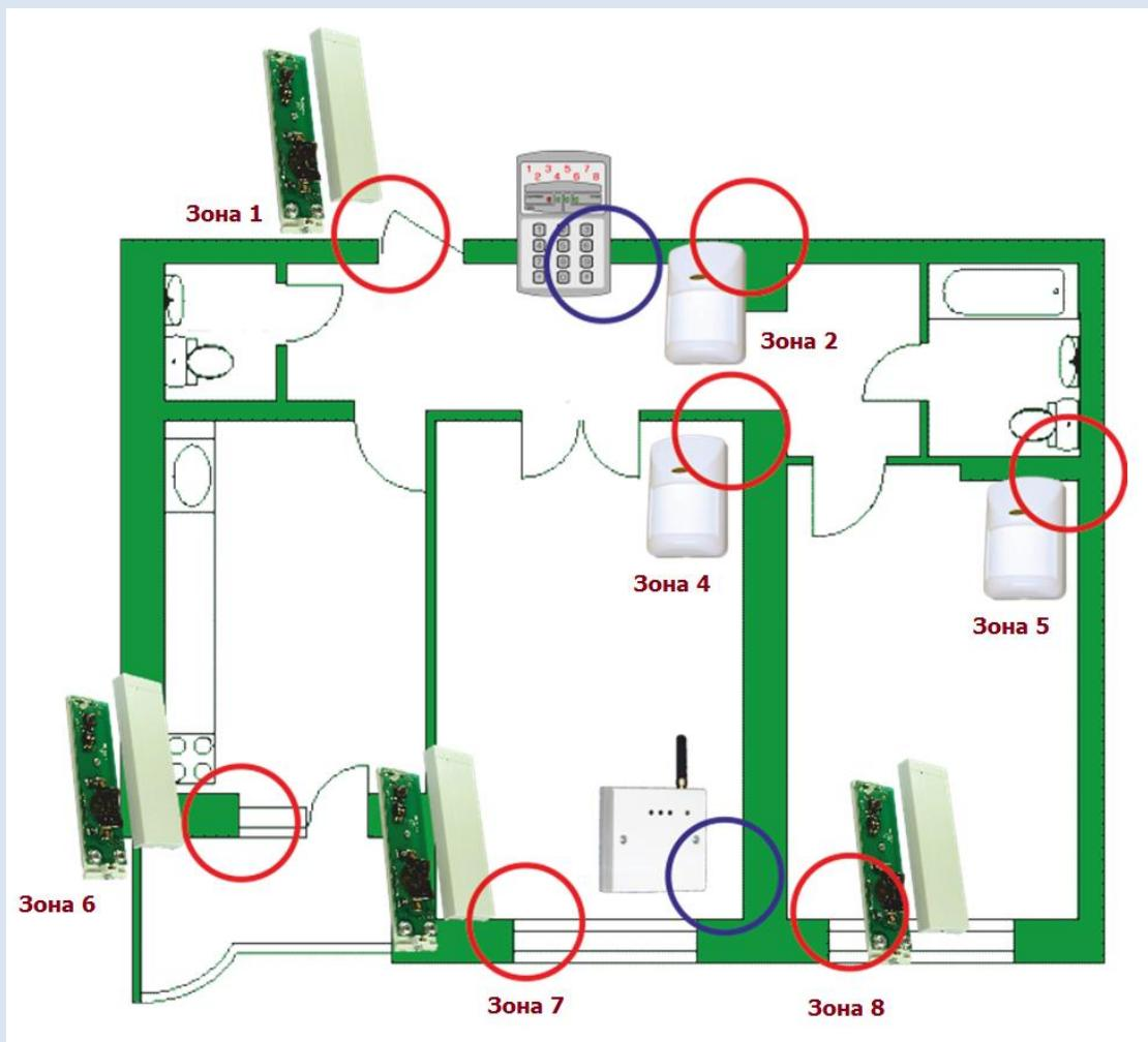
**Рис. 17. Размещение датчиков в квартире**
