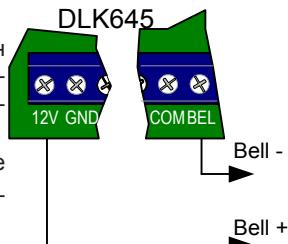
На рисунке показано использование выхода BEL для подачи сигнала тревоги от контроллера на охранную сигнализацию.
