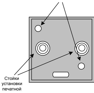
Корпус со снятой крышкой
