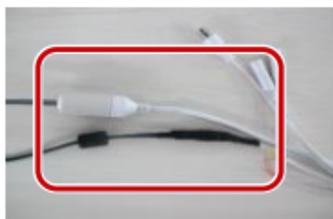
3 Обмотайте торцы неподключенных ответвительных кабелей изоляционной
