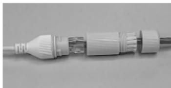
5 Закрутите водонепроницаемый колпачок болта.
